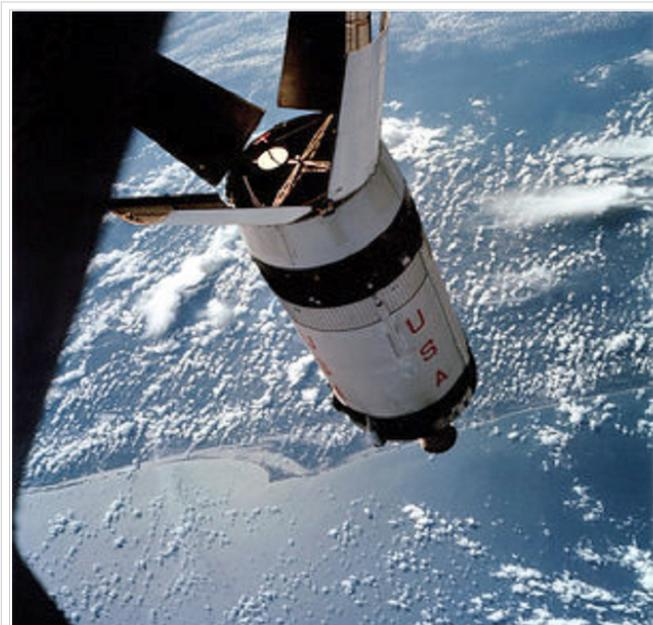
L'étage S-IVB d'Apollo 7 en vol orbital autour de la Terre. Apollo 7 utilisa un lanceur Saturn IB, et non Saturn V, sachant que l'étage S-IVB était quasiment identique sur ces deux lanceurs
