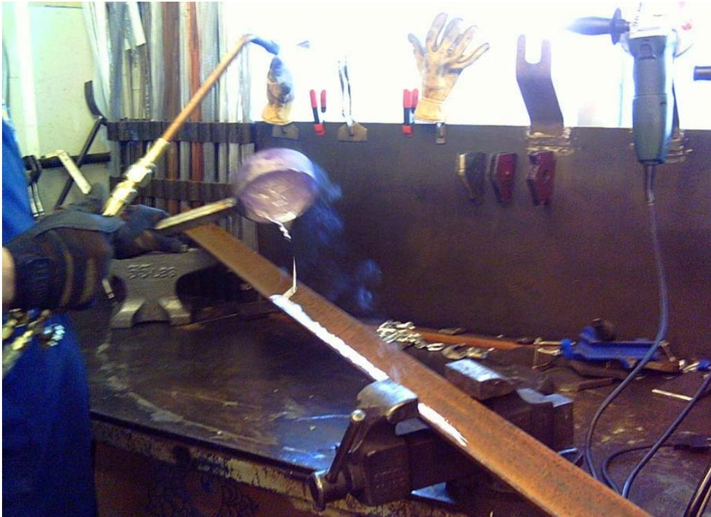
L'aluminium fondu est renversé sur l'acier rouillé : écoulement argenté et aucune réaction violente observée.
