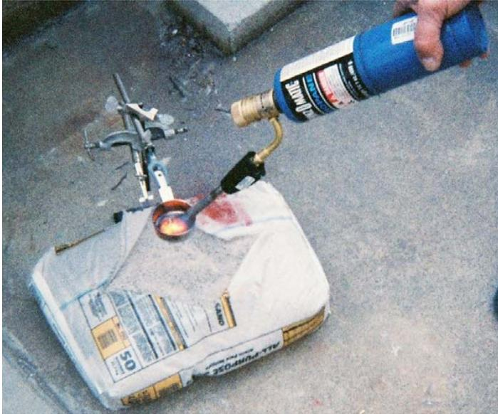
Le Thermite n'a pas pris feu lorsqu'il est chauffé avec un chalumeau au propane.
